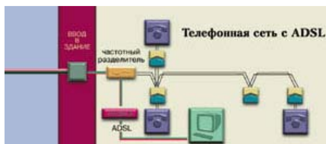
Рис. 12: Схема фрагмента абонентского окончания сети доступа, построенной на базе технологии ADSL
