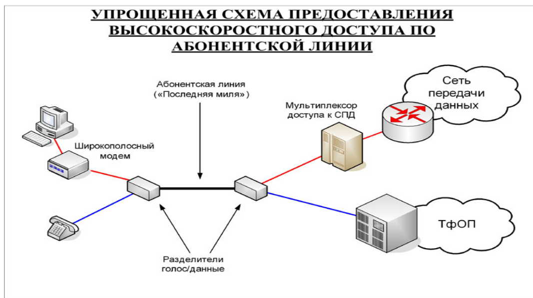
Рис.15: Схема организации цифрового абонентского доступа.
