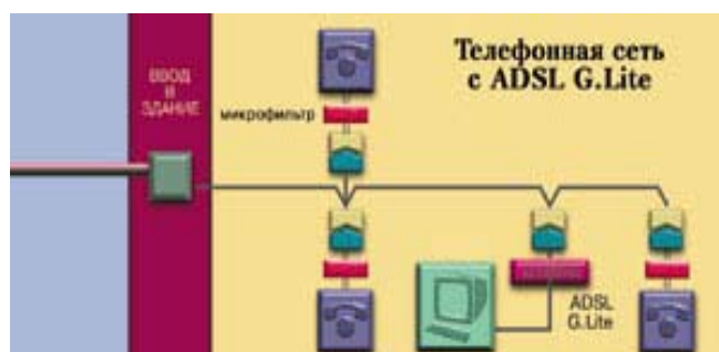
Рис. 13: Схема фрагмента абонентского окончания сети доступа, построенной на базе технологии ADSL G Lite.
